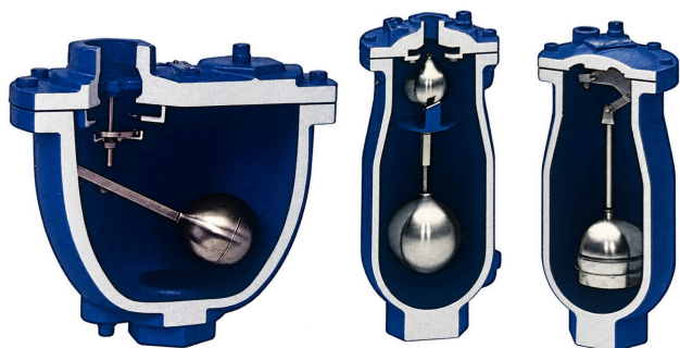
VALVULAS VENTOSA AIRE & VACIO, ALIVIO DE AIRE Y TIPO COMBINADAS. CONEXION FLANGE E HILO NPT. CARACTERISTICAS: FIERRO FUNDIDO A 126 GR. B, HIERRO DUCTIL A 536, ACERO CARBONO A 216 WCB, ACERO INOXIDABLE 316, ALEACIONES ESPECIALES. 1500 PSI CWP.
