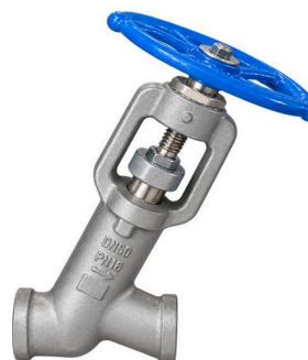
VALVULAS DE ALTA PRESION Y TEMPERATURA, TIPO GLOBO Y, BONETLESS. CONEXION HILO NPT, SOCKET WELD Y BUTT WELD. CARACTERISTICAS: ACERO CARBONO FORJADO A 105, ACERO INOXIDABLE FORJADO A 182F316, CHROME MOLY A 182 F22 Y F91. OTRAS ALEACIONES ESPECIALES. CLASES: 1690, 2680 Y 4500.
